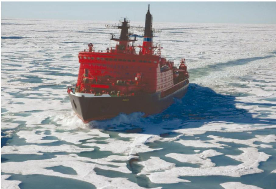
4.2.2г. Очень сплоченный лед (9—10 баллов). Разрушенность 2 балла.
