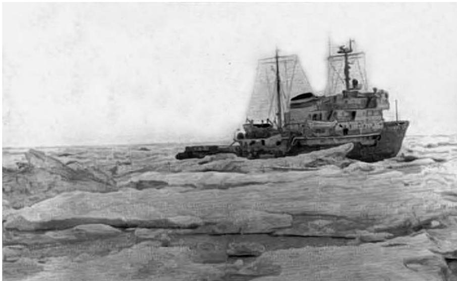
12.1б. Зажатое (затертое) льдом судно.
